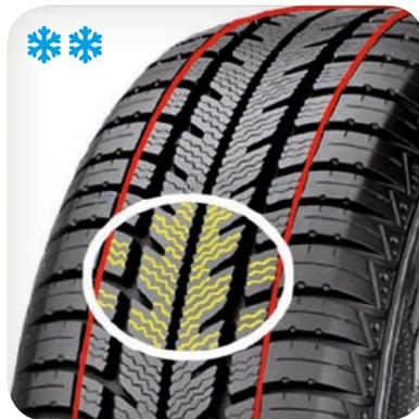
Ganzjahresreifen kombinieren verschiedene Profilarten, die teils für den Sommer, teils für den Winter entworfen sind. Lamellen (hier gelb hervorgehoben) befinden sich in diesem Beispiel nur im mittleren Bereich der Lauffläche.
