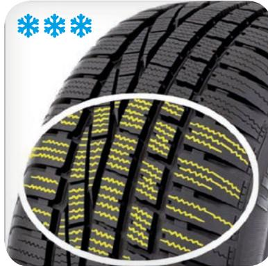
Der Winterreifen hat klar erkennbare Lamellen auf der gesamten Lauffläche bis in die Reifenschulter. Lamellen sind feine, meist zickzackförmige Einschnitte in den Profilblöcken (hier gelb hervorgehoben). Sie bilden zahlreiche Griffkanten für den Schnee auf der Fahrbahn.
